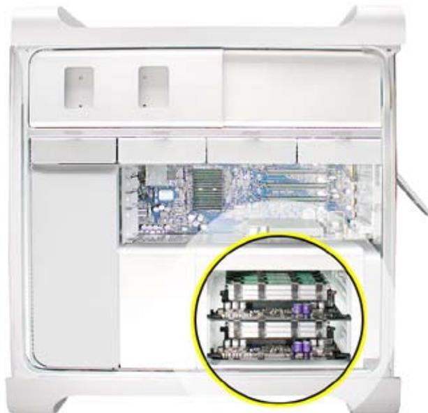
3. 2つの指穴でメモライザカードを持ってメモリケージからカードを引き出し、DIMM 側を上にして、柔らかく清潔な布の上にカードを置きます。
