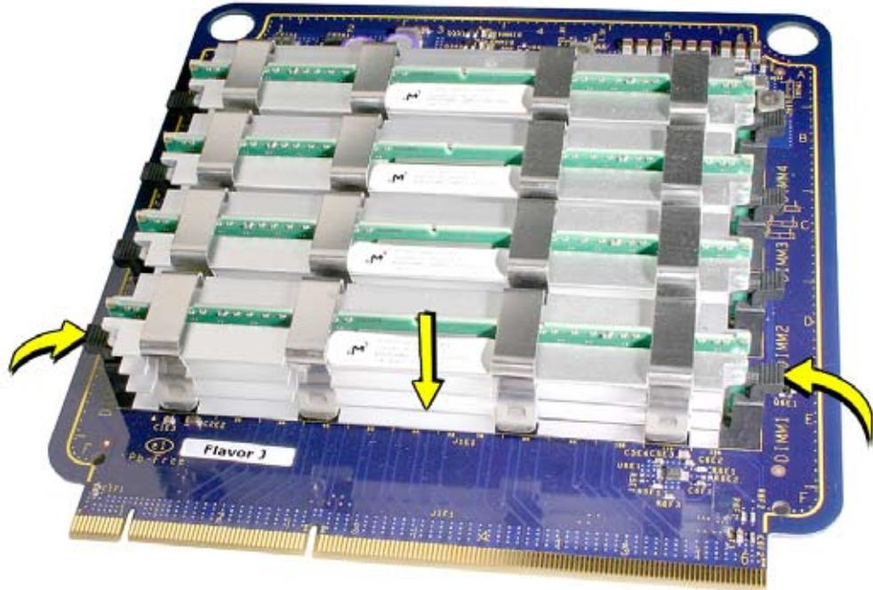
2. ロジックボードのメモリスロットにはまるまで少しずつカードを押しながら、交換用のライザカードをメモリケージの所定の位置に挿入します。
