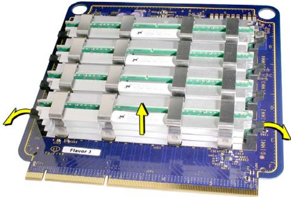
**警告：**FB-DIMM は、DIMM の片方にヒートシンクが付いています。DIMM からヒートシンクを取り外さないでください。取り外そうとすると、DIMM を損傷する可能性があります。
